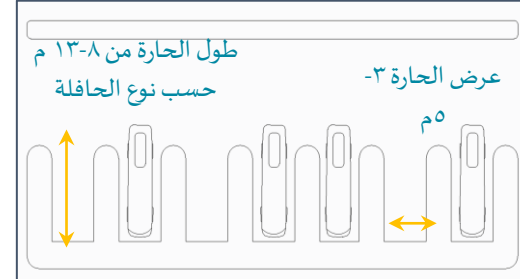
حارات عمودية Perpendicular bays: محاذاة عمودية لزاوية ٩٠ درجة
