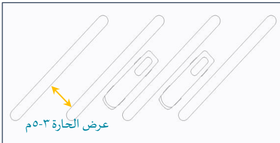
حارات عبور Drive through: مرتبة بشكل متوازي عند ٩٠، ٦٠، ٤٥، ٣٠ درجة
